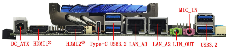
双 HDMI 双网接口示意图↓（QM1200 QM1300 QM1400 接口一样）
